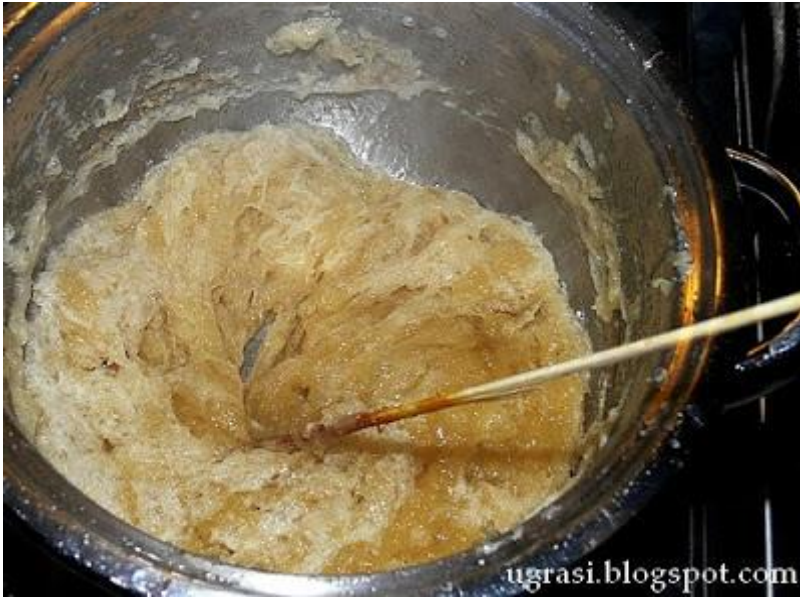
Görüntü 8: Katılaşmaya Başlayan Sabun. Çözelti Bitene Kadar Eklenmeli.
